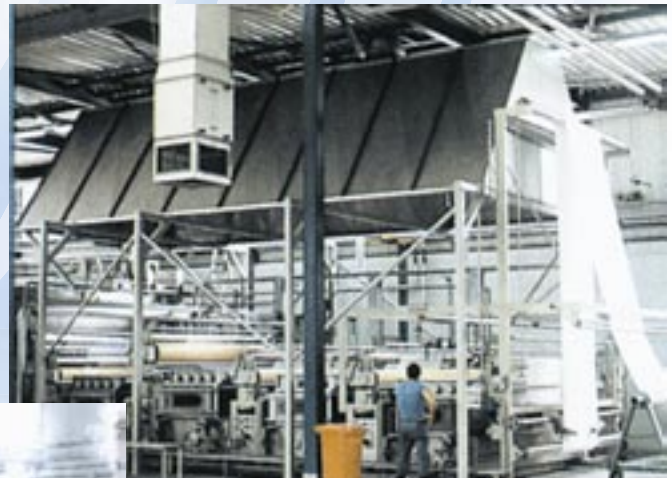
Afzuiginstallatie chloorbleekloogstraat Afzuigkap uit RVS 316 : 22 x 4 meter Afzuigcapaciteit : 72.500 m 3 /h
