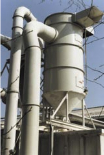
Patronen Filter type 48/21 met een doekoppervlak van 1008 m 2 Toepassing : afzuiging productielijn snacks Capaciteit: 60.000 m 3 /h
