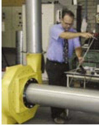
Capaciteitsmeting ventilator in de R&D-afdeling.
