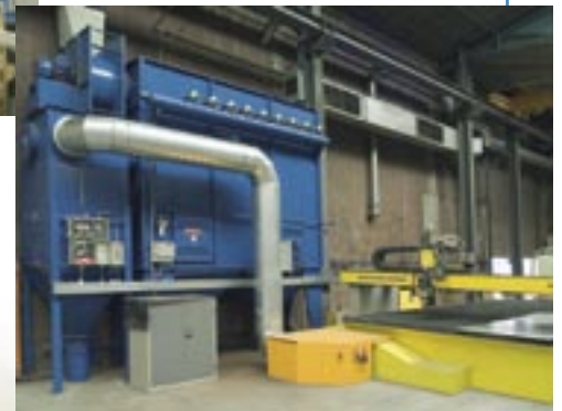
Patronen Filter type 20/21 geplaatst achter een plasmasnijmachine met voorafscheider en vonkenvanger. Capaciteit : 8.500 m 3 /h
