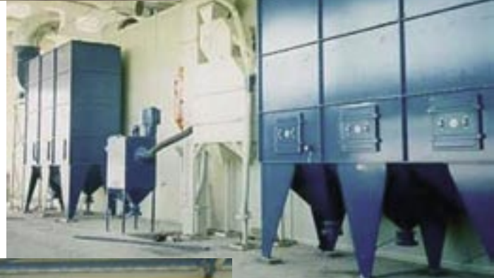
Slangen Filter type SMKT-225 voor afzuiging van een straalcabine voor treinstellen. Afzuigcapaciteit : 81.000 m 3 /h
