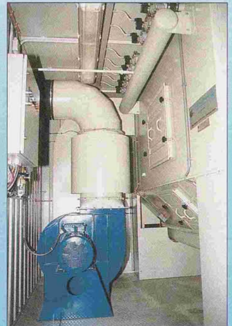
Pat Jet 16/13 met schroeftransporteur ingebouwd in 10 Voetcontainer, ventilator B 18¼, 11.000 m³/h. Toepassing afzuiging conservering buiten voor bruggen en chemische plants.
