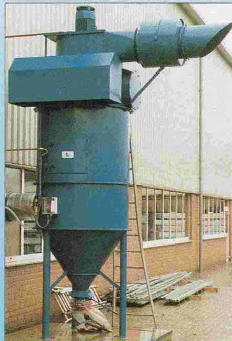
Een Pat Jet 7/13 met ingebouwde centrifugaal voorafscheider voor afzuiging van een brandsnijmachine voor aluminium.
